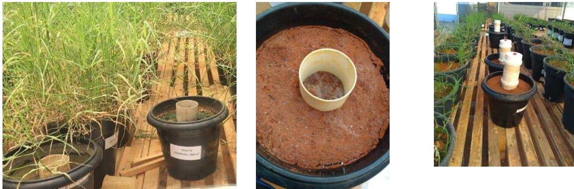
Figura 1: Detalhes das câmaras de coleta de CO 2 dispostas nos vasos no experimento de casa de vegetação.
