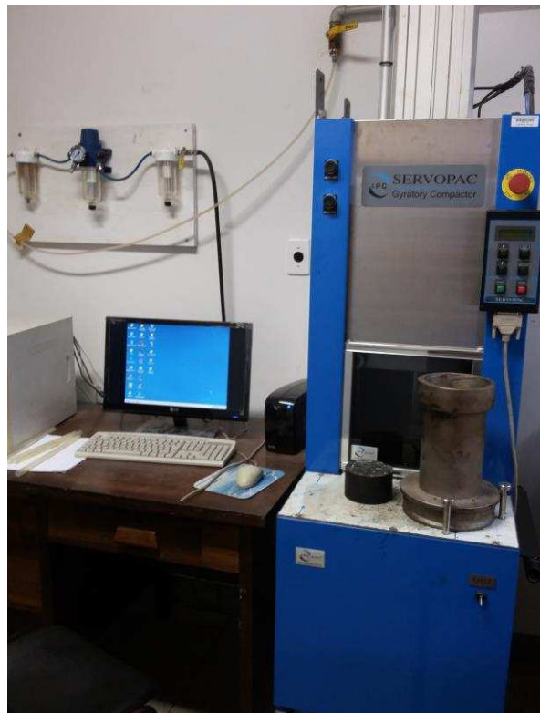
Figura 19: Compactador Giratório Superpave do Laboratório de Engenharia Civil da Universidade Federal de Viçosa.
