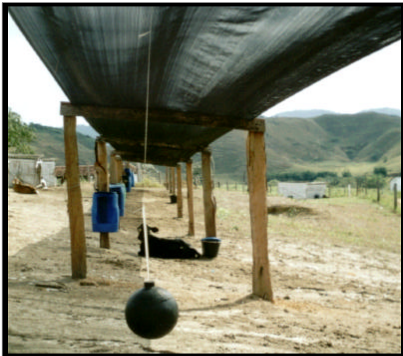
Figura 5 - Termômetro de Vernon instalado sob sombrite.
