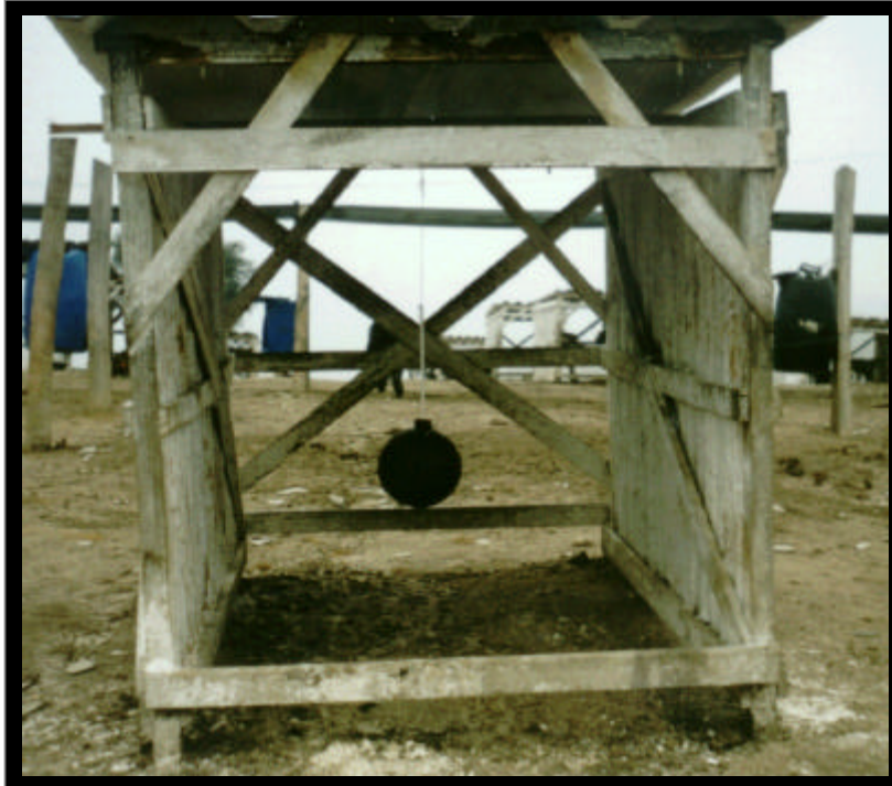
Figura 4 - Termômetro de Vernon instalado em abrigo móvel.
