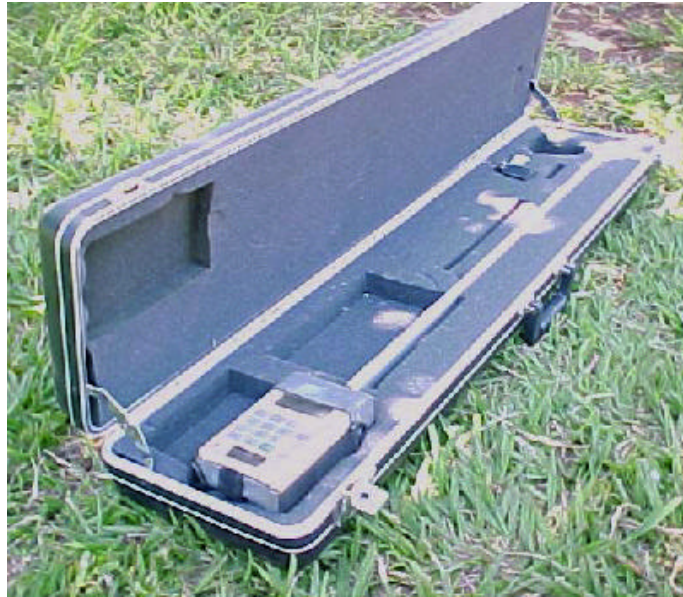
Figura 11 – Aparelho analisador de dossel utilizado para o monitoramento da interceptação luminosa pelo dossel forrageiro.
