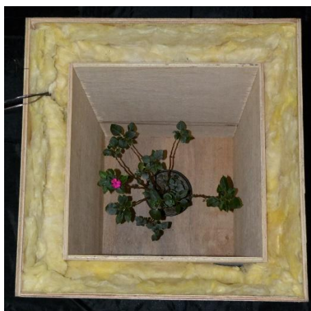
Figura 3: Planta no interior da câmara acústica. As plantas foram inseridas nas câmaras e as tampas das caixas interna e externa foram fechadas para exposição aos Tratamentos Sem exposição ao Som (TSS) e Tratamento Som das Cigarras (TSC).
