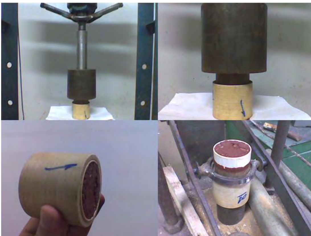
Figura 4.8 – Compactação das amostras no anel de PVC.
