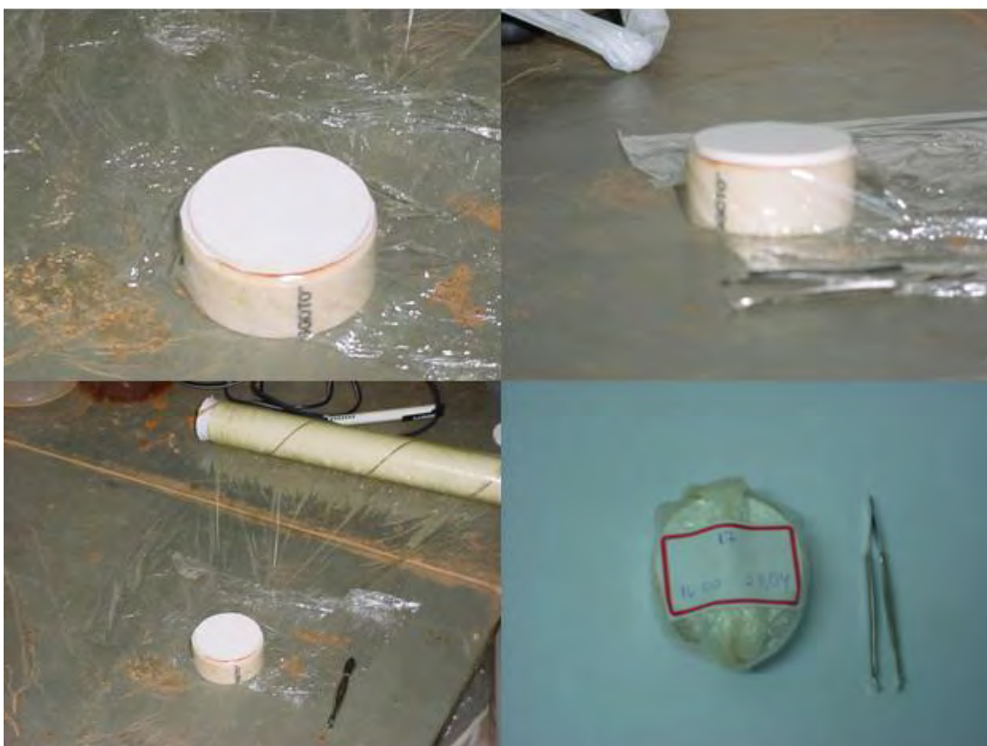
Figura 4.9 – Colocação do papel filtro e isolamento do corpo de prova
