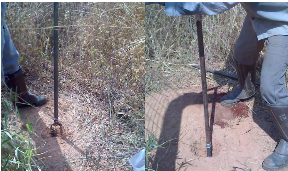
Figura 4.6 – Escavação de poços na cobertura e retirada de amostras deformadas com auxílio de trados manuais
