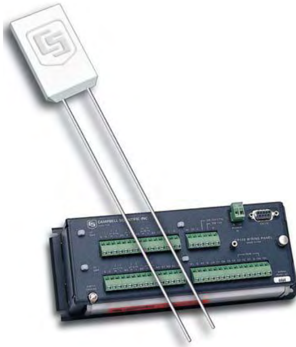
Figura 4.5 – Instrumento para medir umidade em campo WCR utilizado nos experimentos e datalogger, Campbell Scientific, Inc. (Amorim, 2008)
