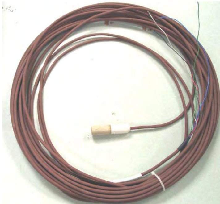
Figura 4.7 – Unidade de dissipação de calor (EPA, 2002)
