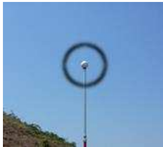
Figura 10: Exemplo de alvo utilizado para auxiliar no levantamento de campo e concatenação da nuvem de pontos.
