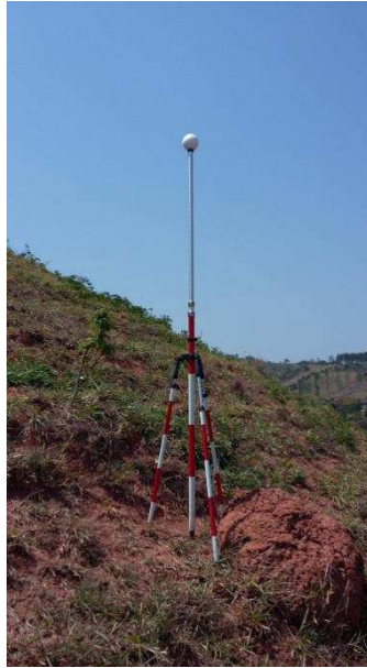
Figura 9: Alvo auxiliar para levantamento em campo.
