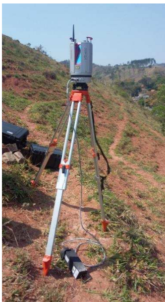
Figura 8: Exemplo do Laser Scanning terrestre em uma das posições em campo.
