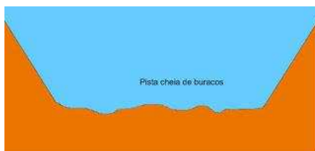
Figura 6: Pista de rolamento com buracos vista transversalmente.
