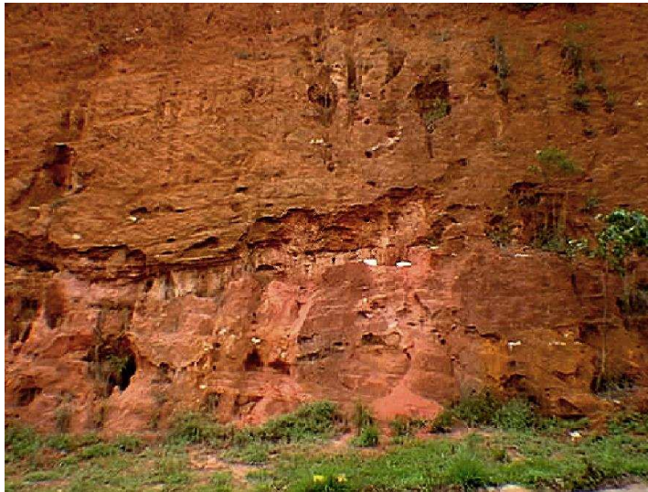
Figura 27: Ilustração de solo residual jovem, classificado pedologicamente como residual jovem ou saprolítico.
