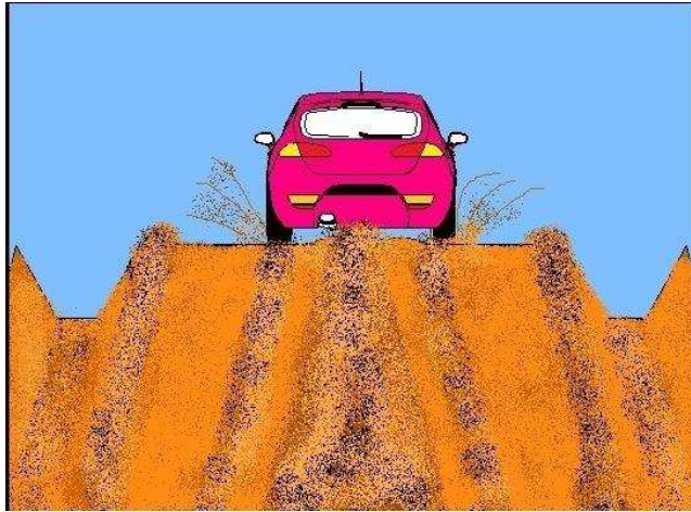
Figura 10: Ilustração do defeito areião de espigão em estrada de terra
