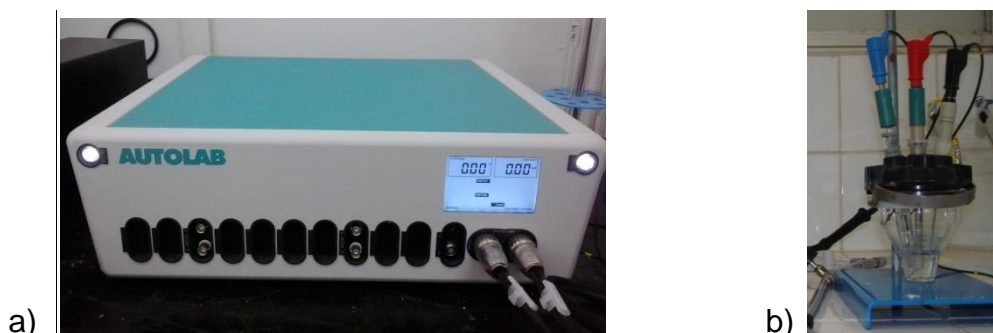
Figura 15. Instrumentação utilizada: a) potenciostato/galvanostato PGSTAT 302N e b) célula eletroquímica com arranjo de três eletrodos
