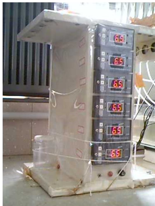
Figura 1 – Sistema de cultivo em batelada com temperatura controlada por banho-maria (a), agitação magnética (b) e controle de pH (c).
