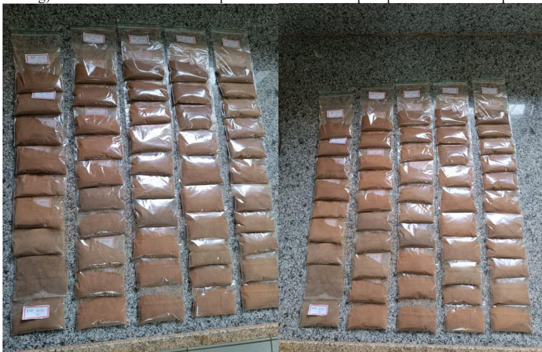
Figura 3 - Aliquotas de Terra Fina Seca ao Ar (TFSA) homogeneizadas, pesadas (aproximadamente 30 g) e acondicionadas em sacos plásticos identificados para posterior análise espectral.
