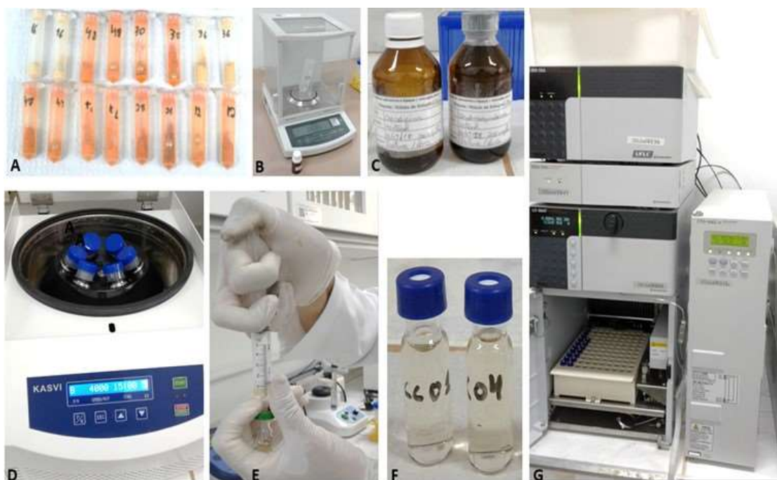
Figura 7: Procedimentos para determinação da capsaicina e dihidrocapsaicina. A) Amostras de pimenta moída; B) pesagem da amostra; C) solução-padrão de capsaicina e dihidrocapsaicina; D) centrifugação das amostras; E) filtração em membrana de 0,45 µm; F) amostras filtradas; e G) injeções do filtrado em HPLC. UFV, Viçosa, 2019
