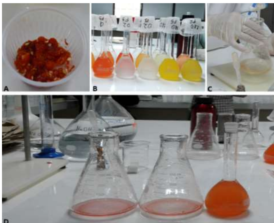
Figura 6: Procedimento para determinação da acidez titulável na polpa do fruto da pimenta. A) 5 g de polpa do fruto triturado; B) suco do fruto; C) titulação com NaOH 0,005 mol L -1 ; e D) solução após titulação. UFV, Viçosa, 2019
