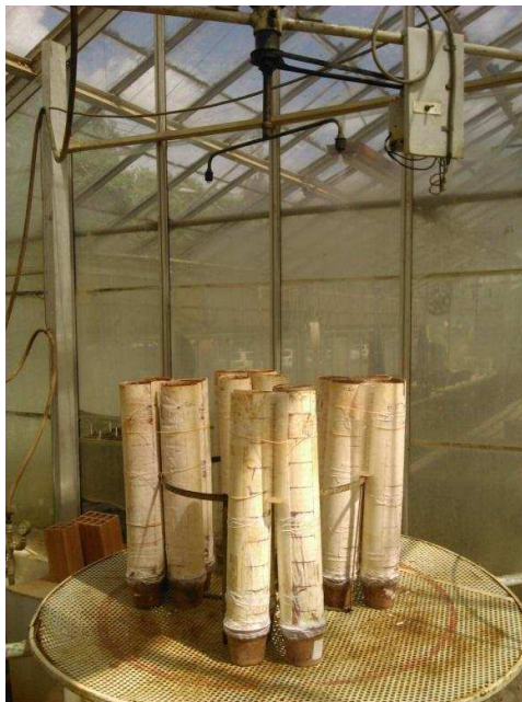
Figura 11- Vista parcial do equipamento ( made in home ) utilizado para simular chuva de 60 mm, no topo das colunas de lixiviação.
