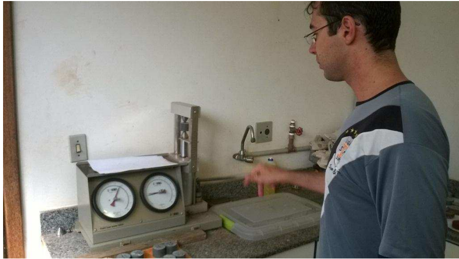
Figura 8 - Realização de ensaio de carga pontual.
