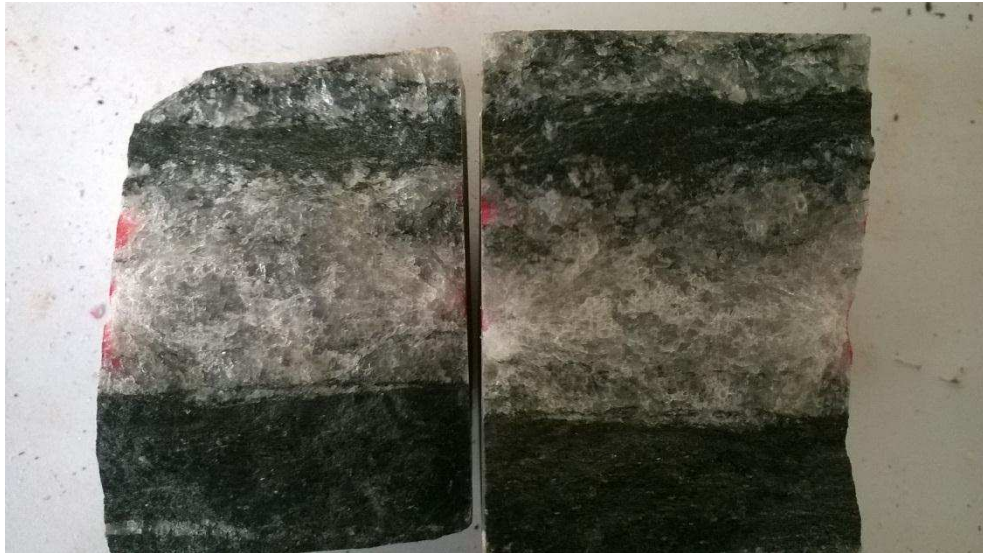
Figura 13 - Corpo de prova de anfibolito quartzoso rompido ao longo de um veio de quartzo.
