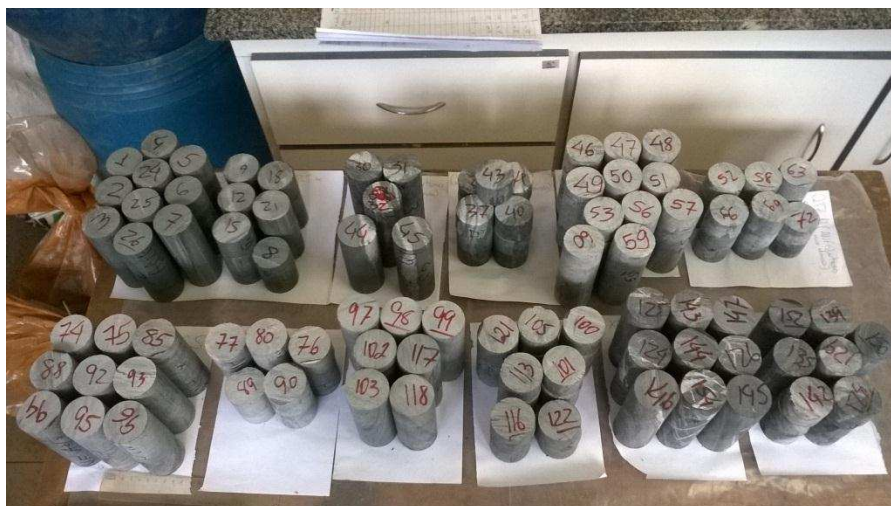
Figura 30 - Preparação de amostras para realização de ensaios de dureza de Schmidt e resistência à compressão uniaxial.
