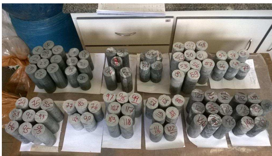
Figura 19 - Preparação de amostras para realização de ensaios de dureza de Schmidt e resistência à compressão uniaxial.
