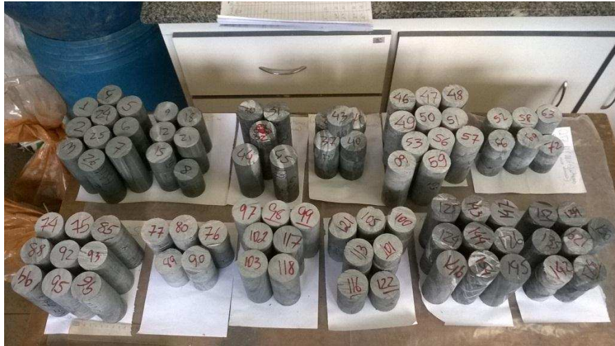
Figura 7 - Preparação de amostras para realização de ensaios de PLT e UCS.
