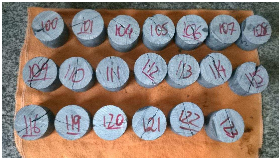
Figura 11 - Rompimentos paralelos às foliações para amostras de anfibolito foliado.
