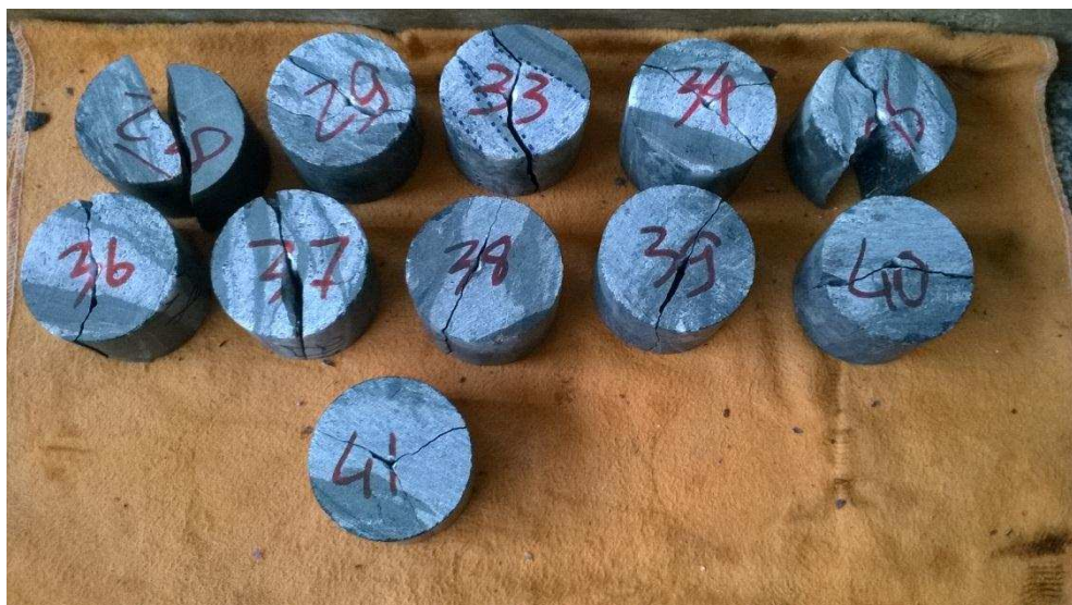
Figura 10 – Rompimentos de amostras de anfibolito quartzoso.
