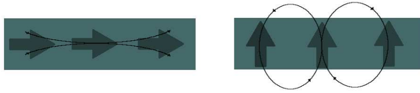
Figura 2.3: A magnetização na direção alongada é energeticamente favorável devido à interação dipolar.
