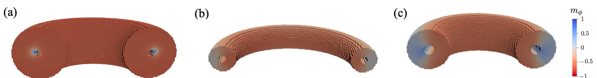
Figura 5.5: Imagens do processo de reversão mediado por a) hópfiõ preso, b) parede de domínio transversais e c) rotação quase coerente. As regiões de azul representam m_\phi = 1 e as regiões em vermelho representam a direção oposta m_\phi = -1 .
