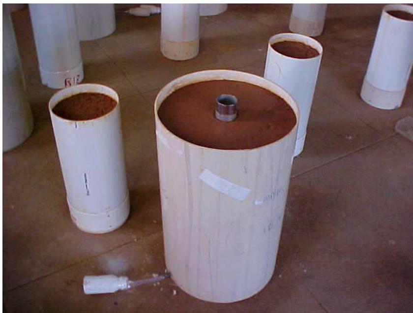
Figura 10 - Vista de uma coluna depois de montada evidenciando o dreno lateral e o frasco coletor. Observam-se, em segundo plano, as colunas menores, denominadas “colunas-auxílio”, usadas na determinação da evaporação.
