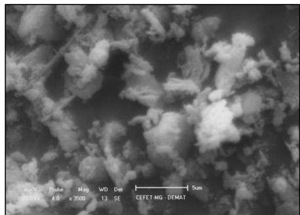
Figura 37 - Microscopia eletrônica de varredura do concentrado de argila da barragem F3.
