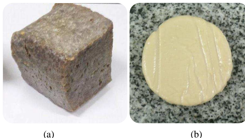
Figura 41. Borracha natural crua (a) e composição contendo borracha e aditivos após mastigação (b).
