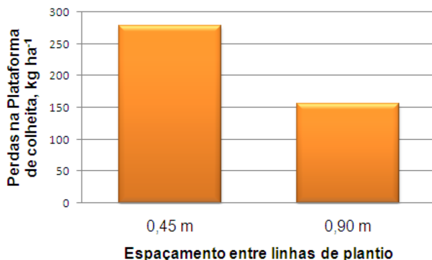
Figura 9- Perdas na plataforma em função do espaçamento entre linhas
