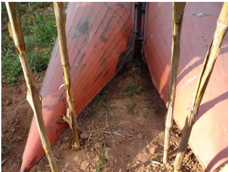
Figura 1 - Alimentação de duas linhas entre divisores na plataforma de colheita
