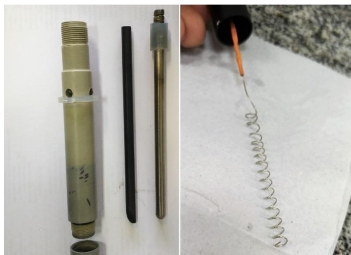
Figura 17. À esquerda cátodos de grafite e aço oxidados. À direita cátodo de platina.
