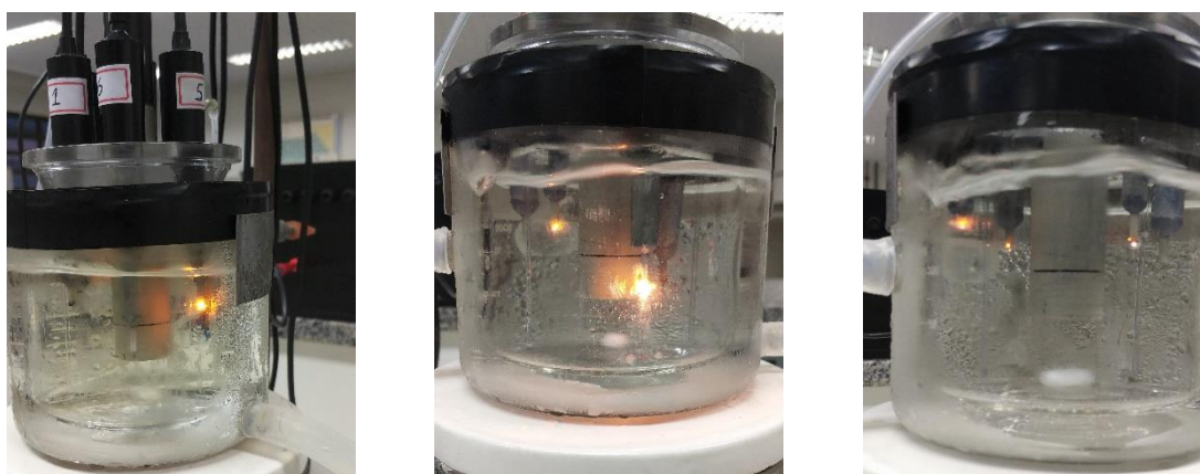
Figura 12. Sistema eletroquímico operando com 1, 2 e 3 ânodos ligados respectivamente da esquerda para a direita na foto.
