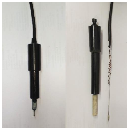
Figura 7. Ânodo de platina. Ânodo montado à esquerda; ânodo desconstruído à direita.
