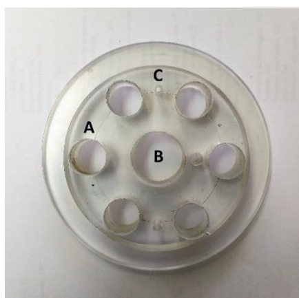
Figura 6. Tampa de acrílico da célula eletroquímica: (A) furos para encaixe de ânodos; (B) furo central para encaixe do cátodo; (C) microfuros de amostragem.
