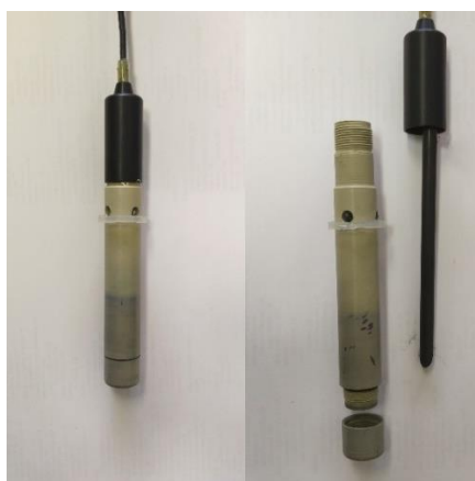
Figura 8. Cátodo de carvão espectroscópico. Cátodo montado à esquerda; cátodo desconstruído à direita.
