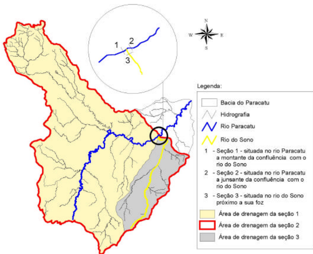
Figura 5. Procedimento para a determinação das áreas de drenagem a montante e a jusante da confluência dos rios Paracatu e do Sono
