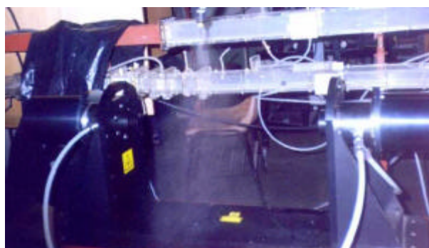
Figura 3 - Analisador de gotas em tempo real a laser.
