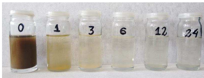
Figura 4. Comparação visual da água residuária do processamento de batata submetida ao tratamento com ozônio em combinação com H_2O_2 em condições otimizadas ( 25\text{ }^\circ\text{C} , \text{pH} = 3,0 e proporção entre H_2O_2/O_3 de 0,1 ) por diferentes intervalos de tempo (1 a 24 h) e controle (0 h).
