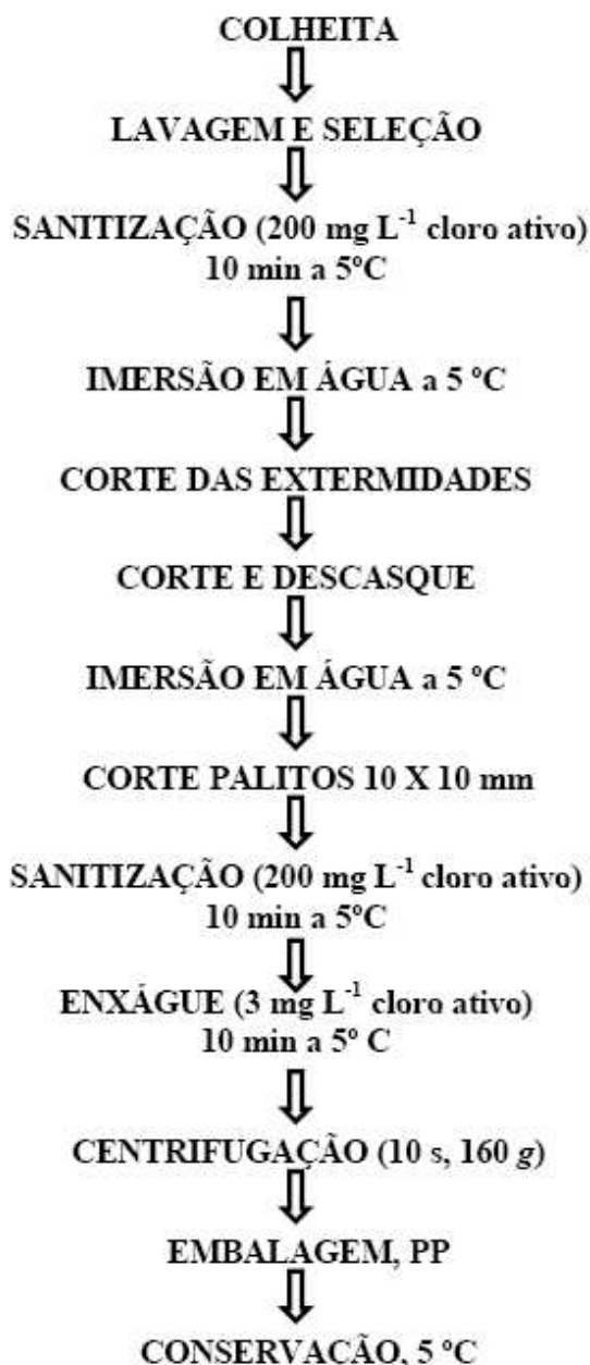
Figura 6. Fluxograma de Processamento Mínimo de Mandioca no Formato Palito. Sanitização e enxágue com composto clorado orgânico, por 10 minutos. Corte em palitos com 100 \text{ mm}^2 de área transversal. Centrifugação a 160 \text{ g} . Embalagem de sacos de PP de 60 \mu\text{m} com 10 \times 15 \text{ cm} . Conservação por até 9 dias, a 5^\circ\text{C} \pm 1 .
