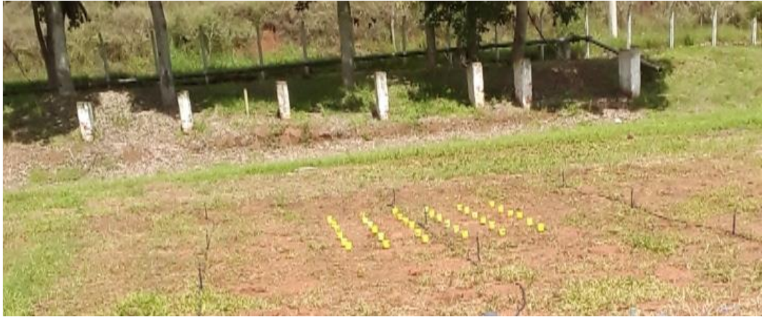
Figura 2.2.4. Avaliação da uniformidade utilizando metodologia de aspersão convencional.
