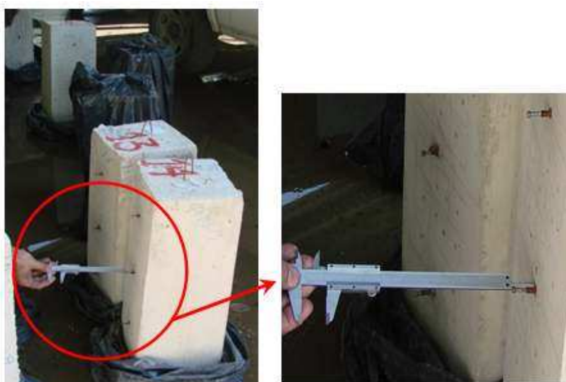
Figura 45 – Leitura do comprimento do pino exposto na superfície do concreto com auxílio de um paquímetro.
