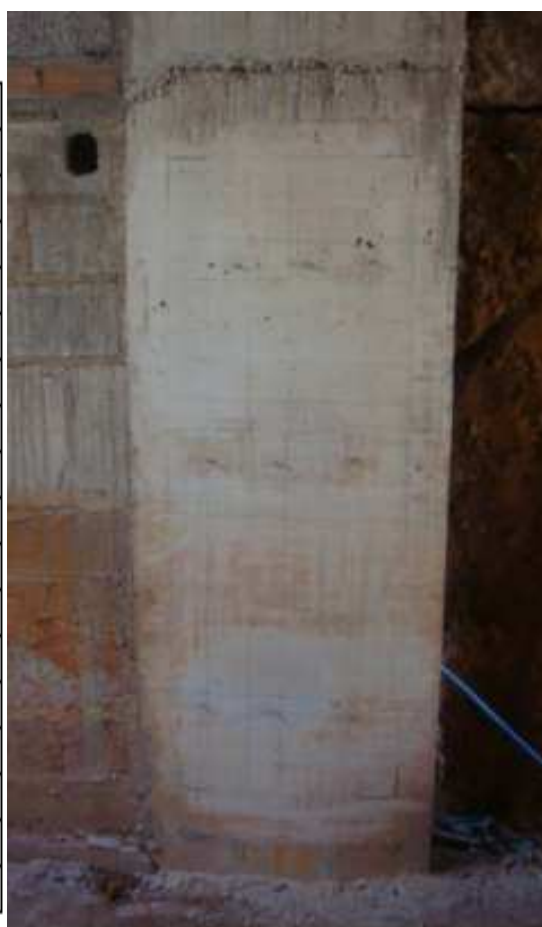
Figura 73 - Resultados de ensaio de esclerometria na superfície de um pilar de concreto armado e vista geral do elemento ensaiado em obra.
