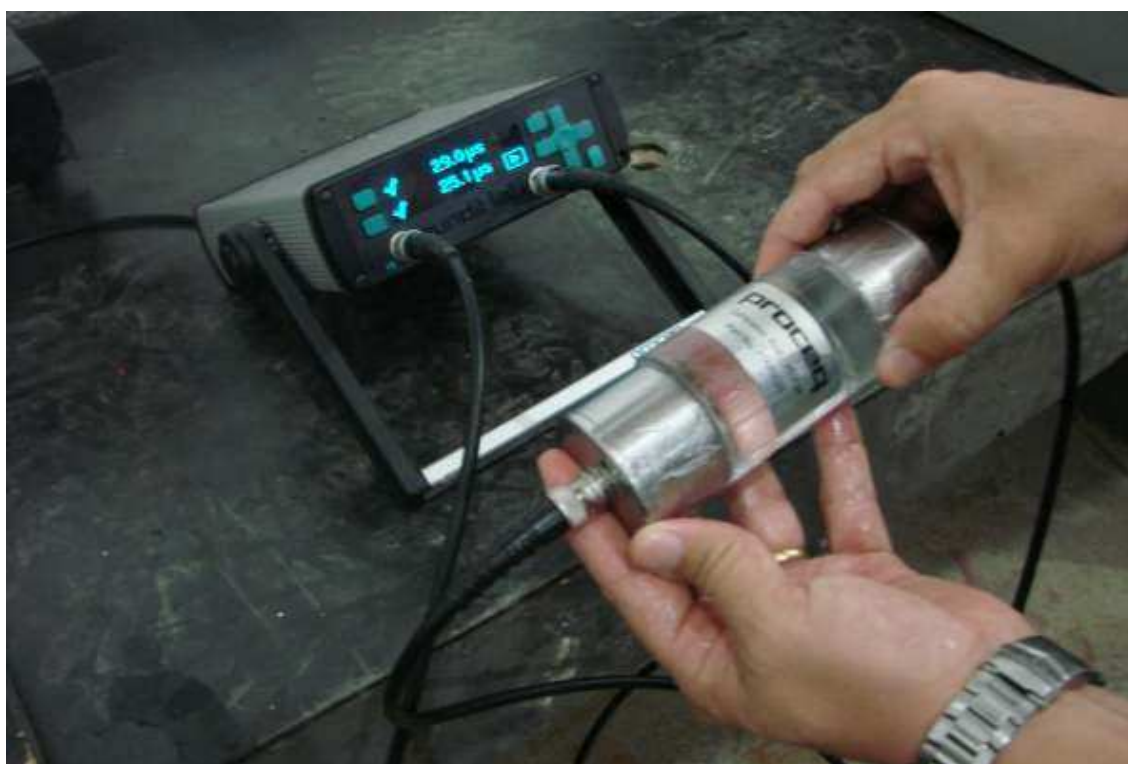
Figura 50– Calibração do aparelho de ultra som.
