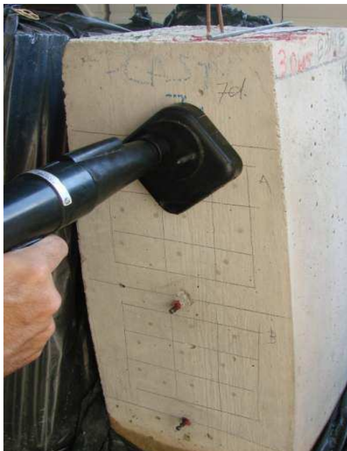
Figura 41 - Realização do ensaio de penetração de pino no prisma.
