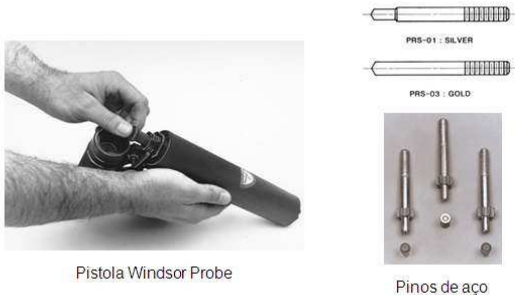
Figura 8 - Pistola finca pino Windsor Probe e acessórios.
