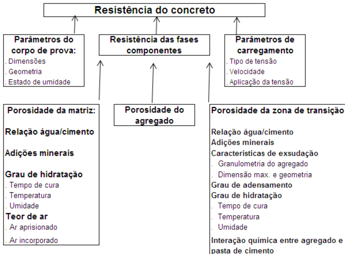
Figura 2 - Fatores que influenciam a resistência à compressão do concreto. (Adaptado de METHA e MONTEIRO, 1994)
