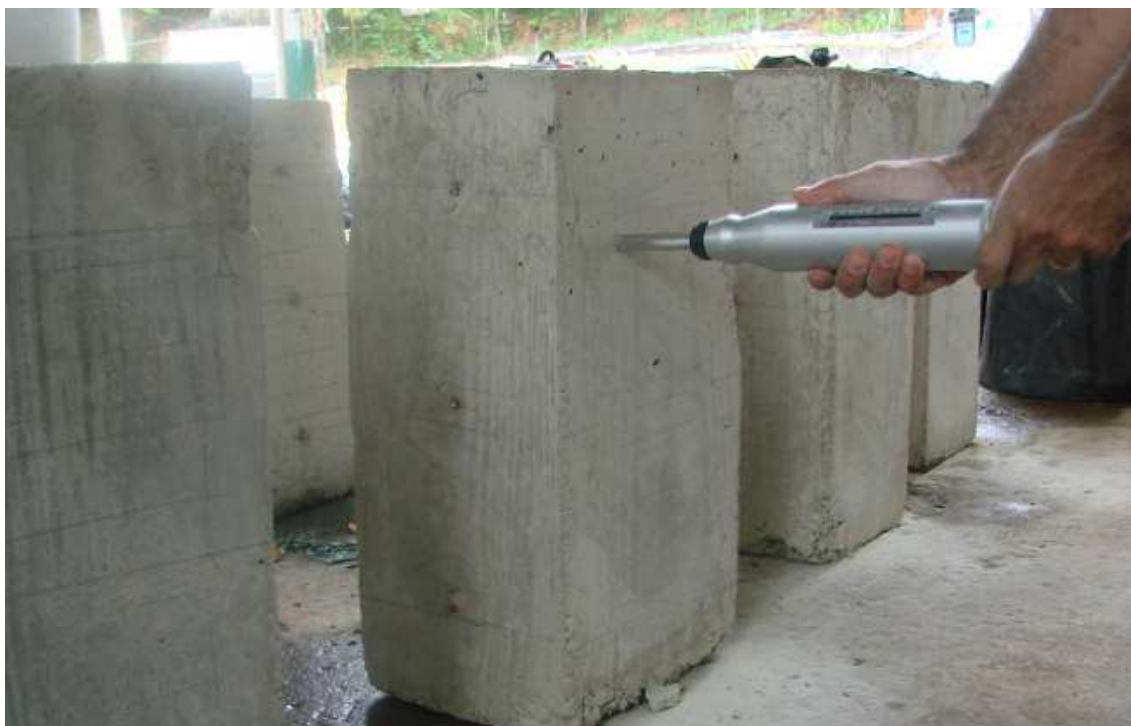
Figura 46 – Realização de ensaio de esclerometria em prisma
