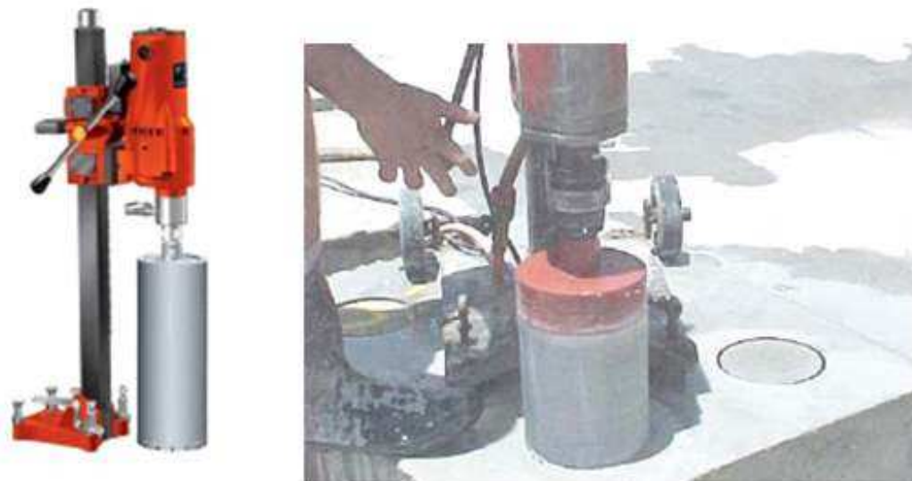
Figura 7 – Equipamento de extração de corpos de prova. (Fonte: Catálogo Amec Equipamentos)
