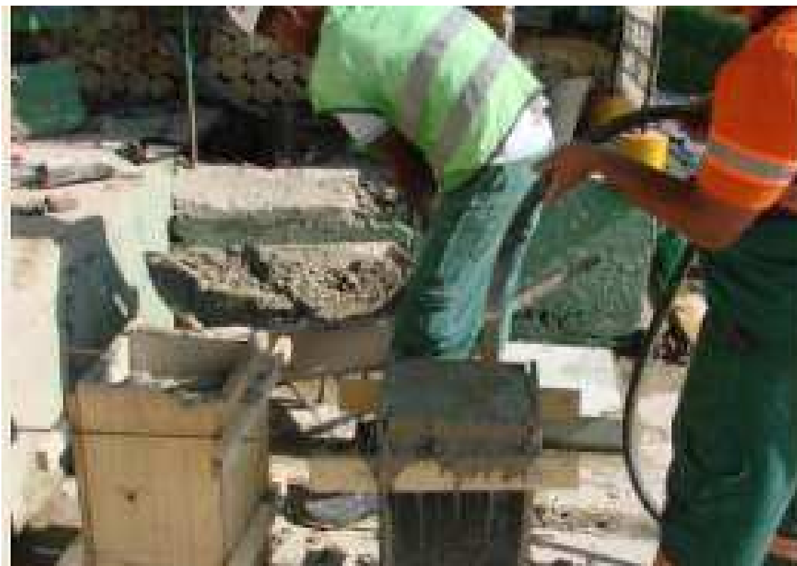
Figura 34 - Moldagem dos prismas de concreto
