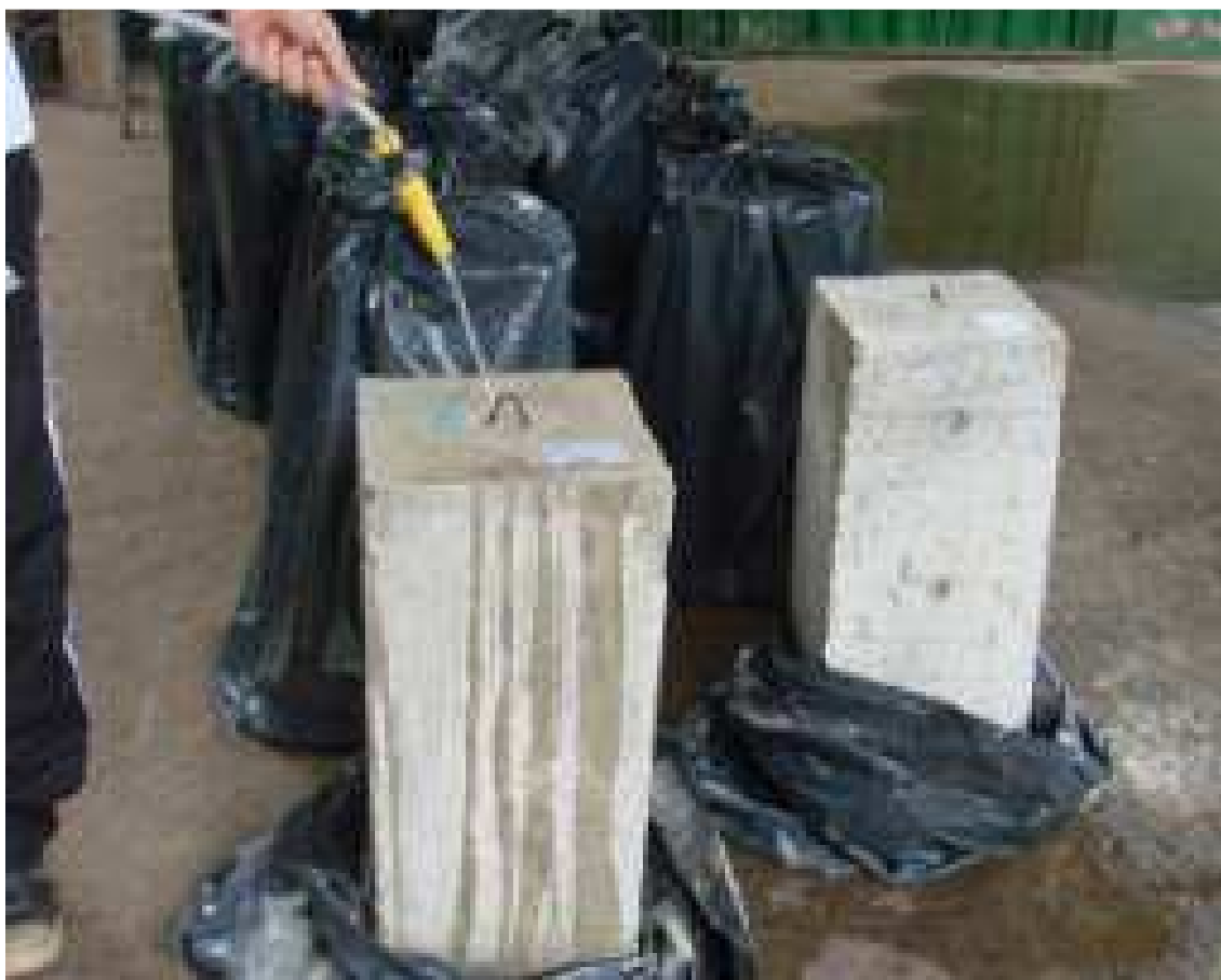
Figura 36 – Procedimento para cura úmida de um prisma de concreto.
