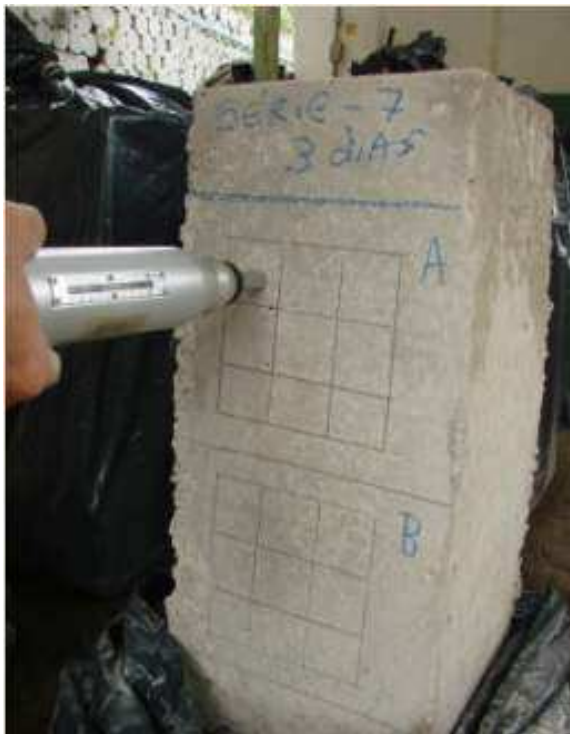
Figura 49- Realização do ensaio de esclerometria em uma das faces do prisma de concreto.
