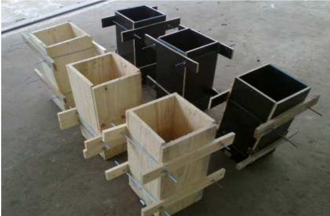
Figura 28 – Aspecto geral das formas em tábua de Pinus e em compensado plastificado.
