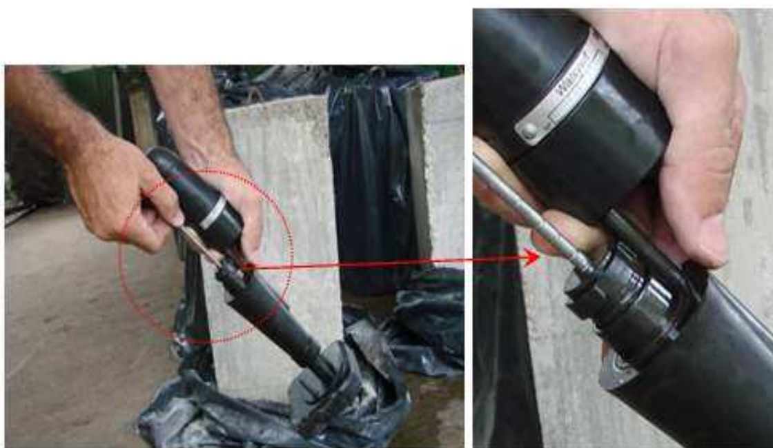
Figura 43 - Calibração do pino na pistola
