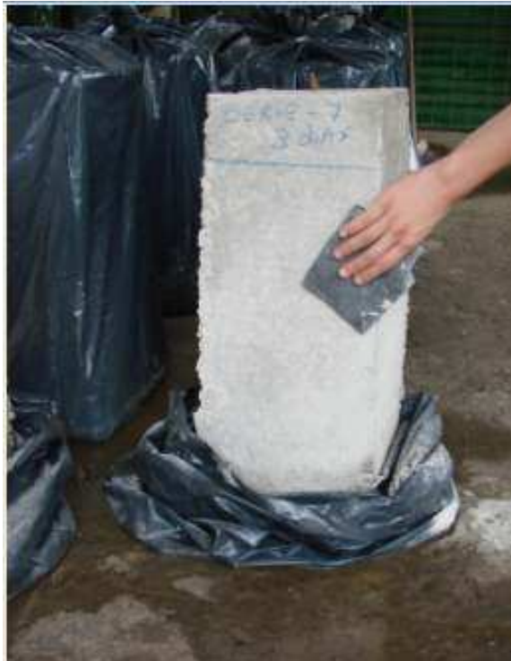
Figura 48 – Preparação das superfícies do prisma de concreto para a realização do ensaio de esclerometria.
