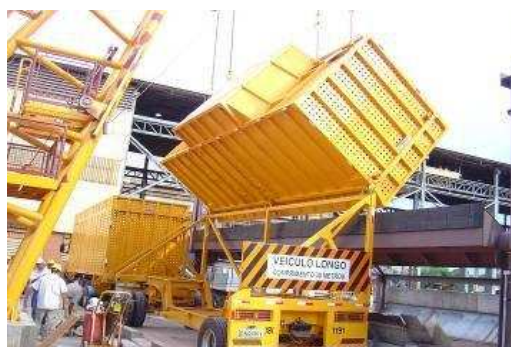
Figura 5 – Descarregamento da cana por bscula lateral. Fonte: SILVA (2006) apud MUNDIM (2009)
