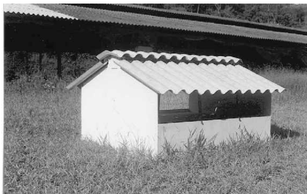
Figura 3.5. Vista do modelo reduzido M2, escala 1:8, com cobertura de telhas de amianto com espessura de 5 mm.
