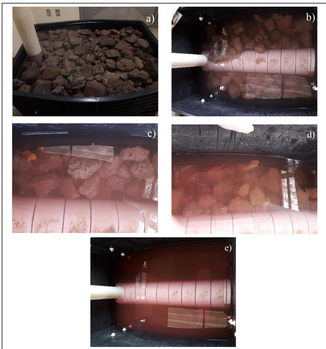
Figura 13 - Registro fotográfico da retida do meio filtrante e presença de rodamina B estagnada no fundo.
