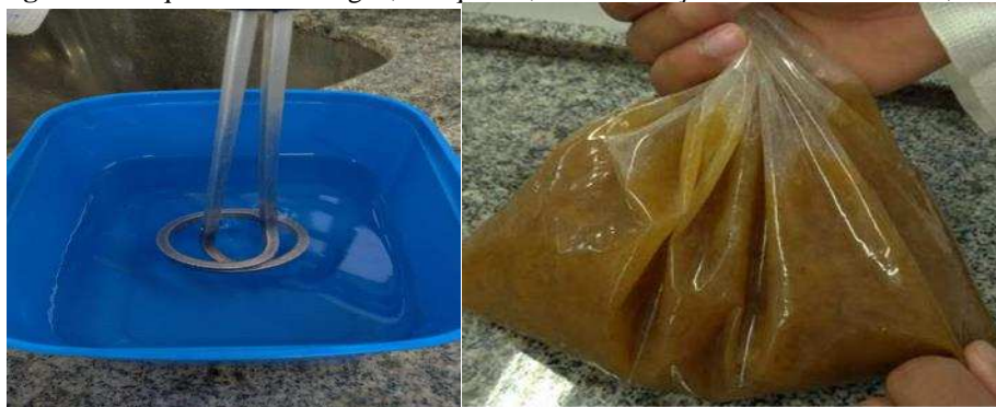
Figura 26: Aquecimento da água, à esquerda, e descoloração do material fibroso, à direita.
