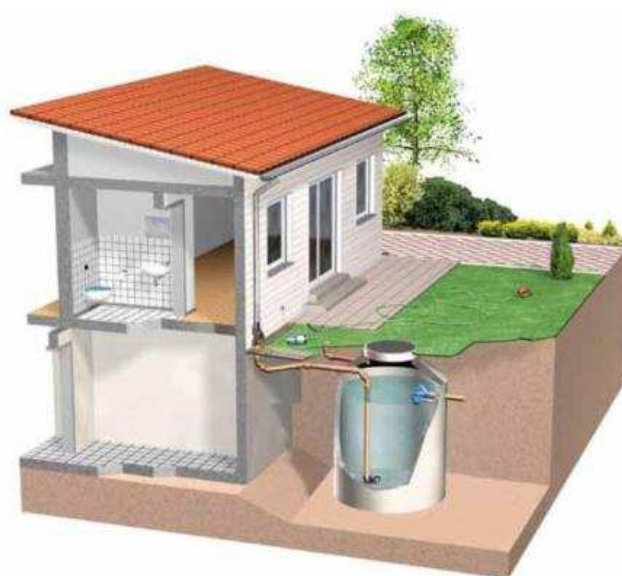
Figura 2-5 Esquema de um reservatório individual
