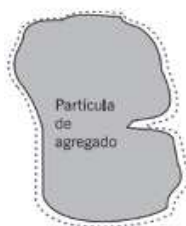
Figura 5 - Esquema da partícula do agregado para determinação da massa específica real.
