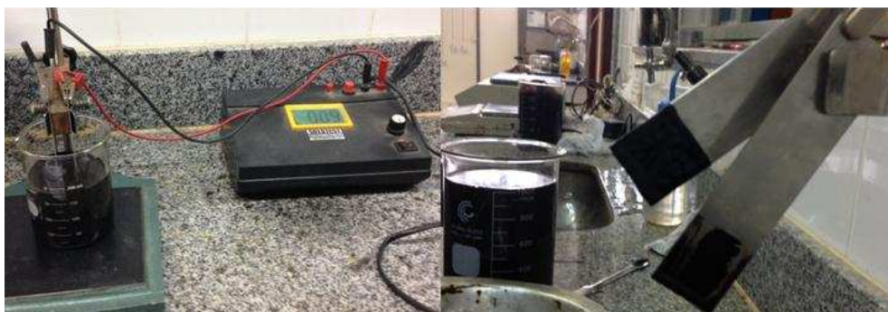
Figura 15 - Apresentação da montagem do ensaio de carga de partícula e o resultado deste realizado no Laboratório de Materiais Asfálticos e Misturas da UFV.
