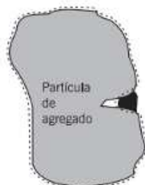
Figura 7- Esquema da partícula do agregado para determinação da massa específica efetiva.
