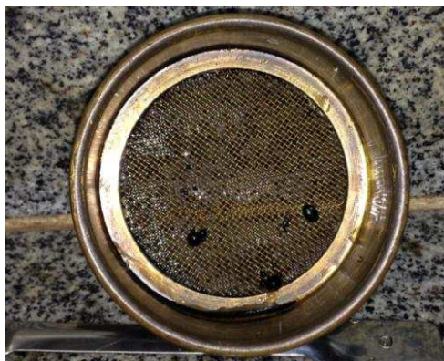
Figura 14 - Ensaio peneiração da emulsão asfáltica utilizada na pesquisa.
