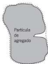
Figura 6- Esquema da partícula do agregado para determinação da massa específica aparente.
