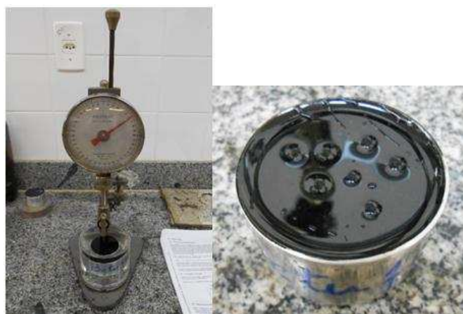
Figura 13 - Equipamento e resultado do ensaio de penetração realizado segundo a ME 155 (DNIT, 2010c).
