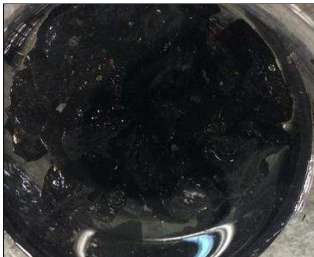
Figura 12 - Adesividade do agregado ao cimento asfáltico modificado com polímeros por adição de Betudope.
