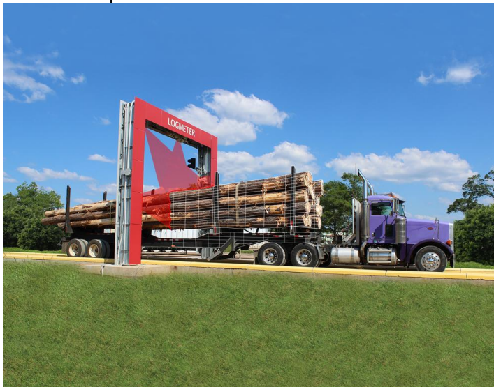
Figura 1 - Sistema automático para estimar o volume de toras de madeira LogMeter
