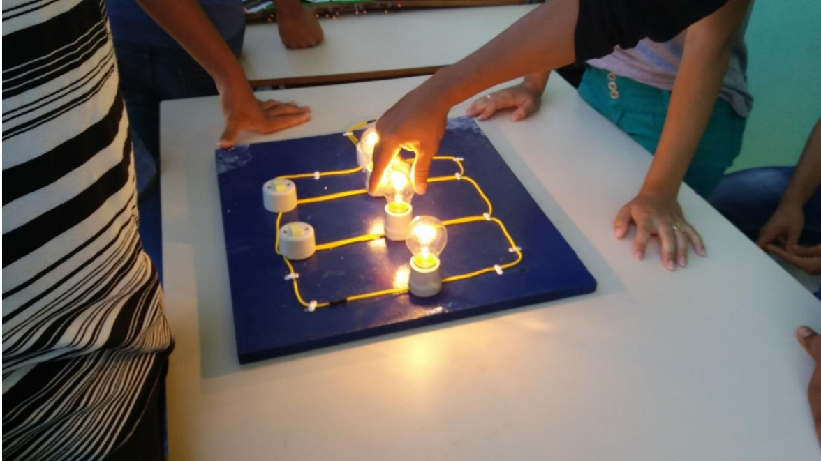
Imagem 8 – Pequeno circuito elétrico com associação mista de resistor.
