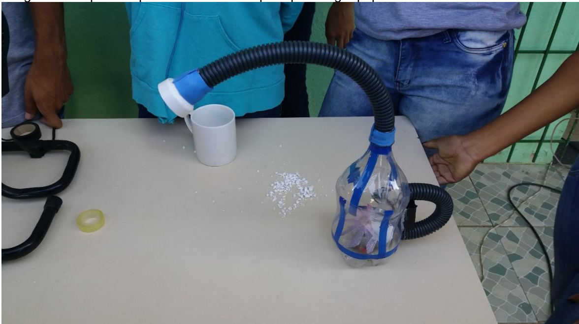
Imagem 7 – Aspirador que usar um motor à pilha para sugar papéis.
