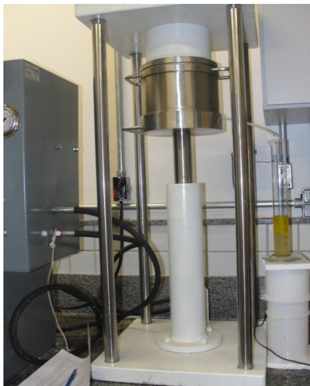
Figura 4 – Prensa hidráulica utilizada para obtenção da fase aquosa a partir do queijo com olhaduras misturado com areia.
