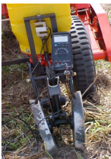
Figura 3 - Multímetro acoplado à roda compactadora.
