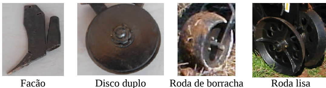
Figura 2 - Mecanismos de abertura do sulco e elementos compactadores.
