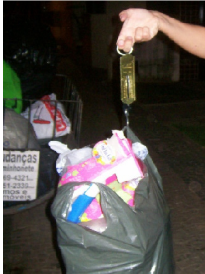
Figura 3.3 - Pesagem dos resíduos sólidos urbanos gerados ao longo da rota de coleta em Viçosa
