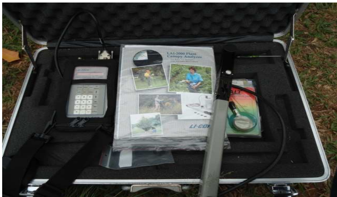
Figura 9 – Aparelho analisador de dossel da marca LI-COR utilizado para o monitoramento do sombreamento do eucalipto e a interceptação luminosa do capim-braquiária.
