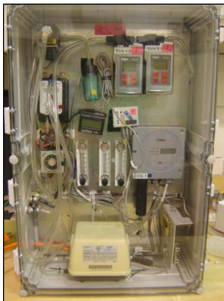
FIGURA 3. UPM: Unidade Portátil de Monitoramento avaliada.
