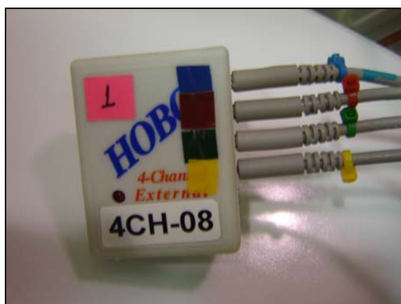
FIGURA 15. Sistema de Aquisição de Dados HOBO de quatro canais utilizado em cada Unidade Portátil de Monitoramento, destinado a armazenar dados de pressão estática, temperatura e estado ligado/desligado do temporizador e dióxido de carbono.
