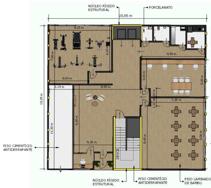
Figura 18 - Planta pavimento térreo - piso laminado de bambu
