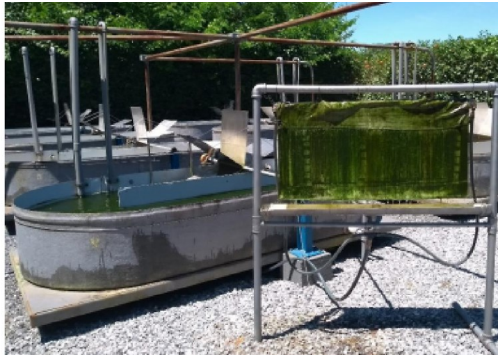
Figura 4.1. Sistema híbrido composto de lagoa de alta taxa e reatores de biofilme (ASSIS et al., 2020).
