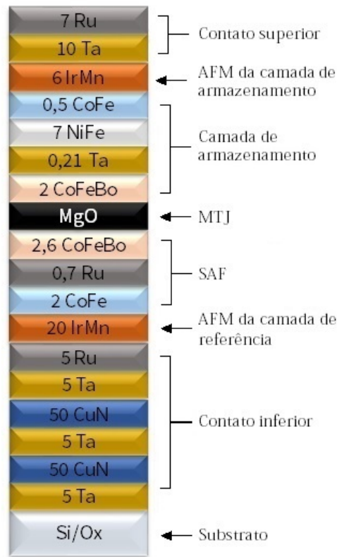
Figura 3.4: Stack da MRAM depositada usando o módulo Timaris MTM no INL.
