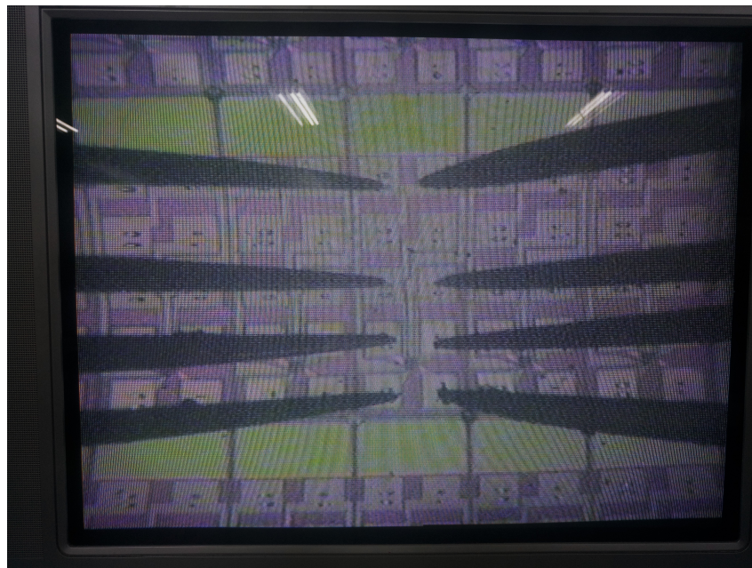
Figura 4.3: Sistema de pontas nos pads do dispositivo de memória.
