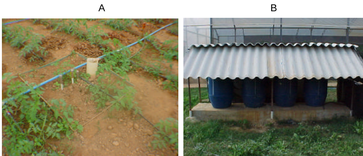
Figura 5 – Vista do lisímetro de lençol freático constante com tensiômetros (A) e tambores de fornecimento de água (B).
