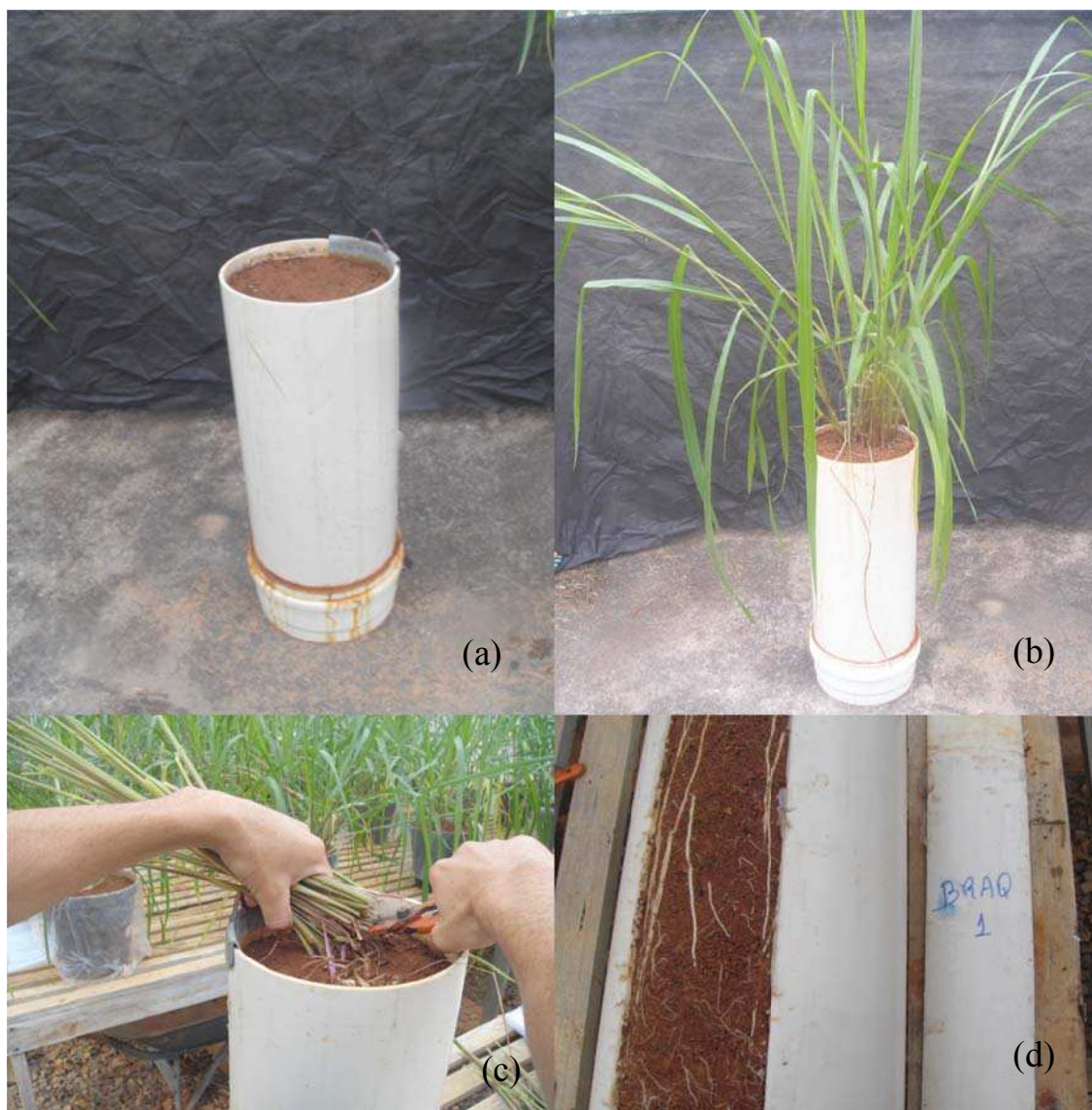
Figura 1. Colunas após 60 dias da montagem (a) sem planta (b) com planta, (c) poda da Brachiaria brizantha e (d) abertura longitudinal das colunas.
