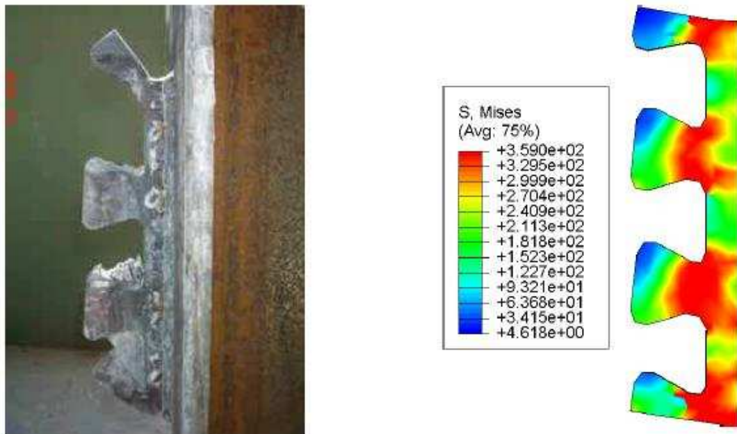
Figura 2-32. Comparação do aspecto de deformação dos conectores ensaiados por Veríssimo (2007) com os modelos numéricos desenvolvidos por Silva (2013) (SILVA, 2013).
