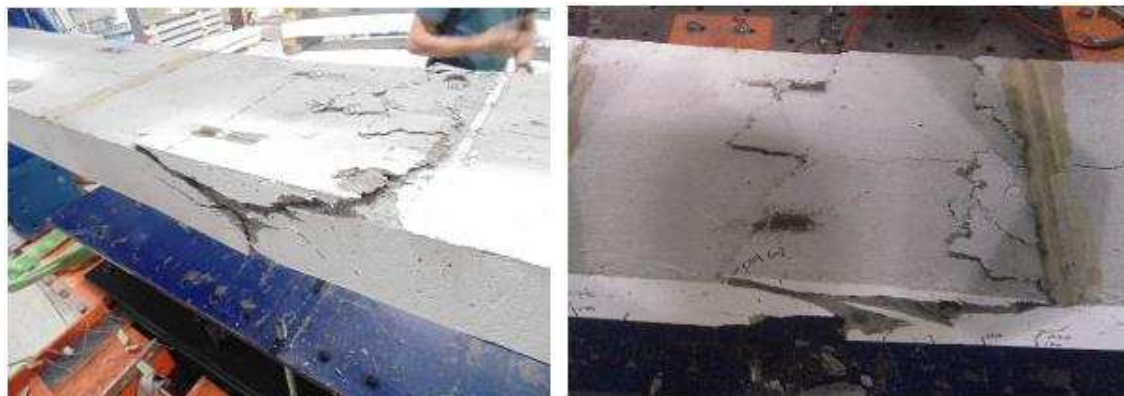
Figura 3-46. Esmagamento do concreto comprimido na região entre pontos de aplicação de carga: (a) VM_Crest_1; (b) VM_Crest_2 (ALVES, 2014).
