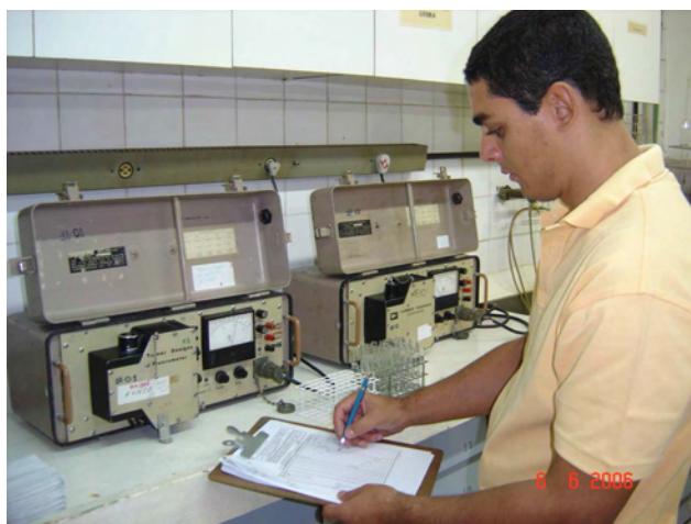
Figura 15 – Determinação das concentrações dos traçadores no Laboratório de Traçadores da COPPE/UFRJ.
