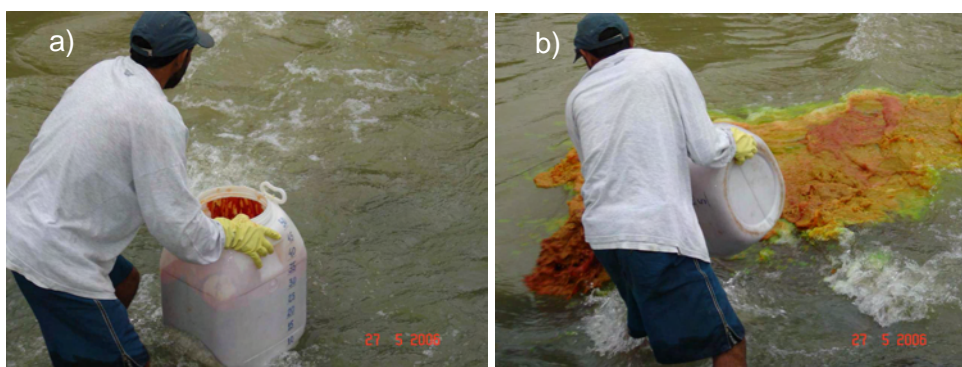
Figura 10 – Injeção instantânea dos traçadores Amidorodamina G e Uranina no Rio Pomba (dia 27/05/2006 as 08:00 h).
