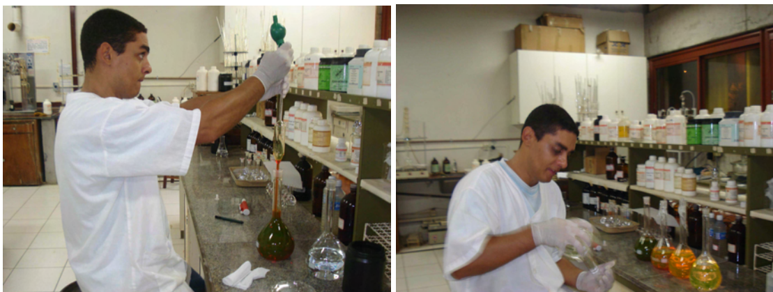
Figura 16 – Determinação, no laboratório de qualidade da água do DEA/UFV, das concentrações-padrão para elaborar a reta de calibração.
