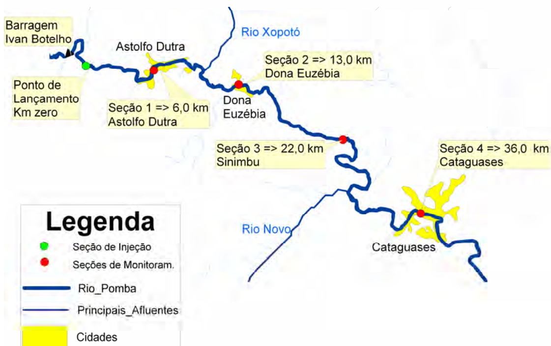
Figura 9 – Seções de monitoramento de traçadores com suas respectivas distâncias em relação à seção de injeção.
