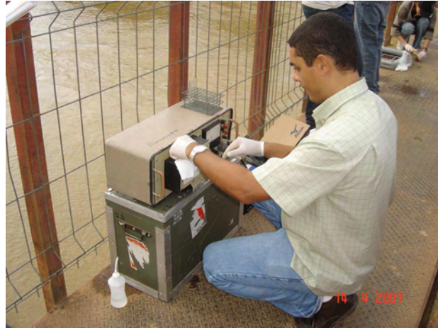
Figura 13 – Detecção do traçador “in loco” através do Fluorímetro.
