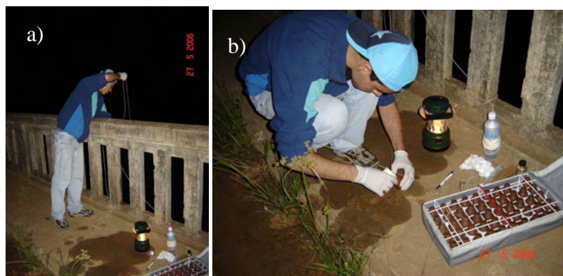
Figura 12 – Coleta e armazenamento das amostras na seção 3 (Sinimbu), vertical 2 a 22,0 km do ponto de lançamento do traçador.
