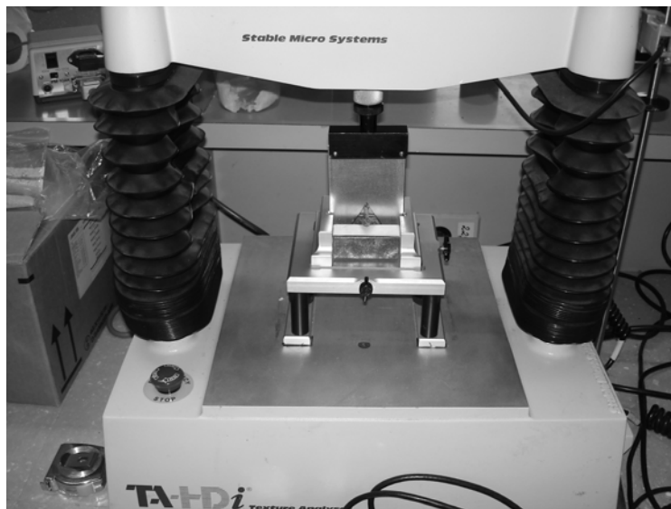
Figura 2.1. Aparelho texturômetro TA.HDi Texture Analyser (Stable Micro System Inc.- USA).
