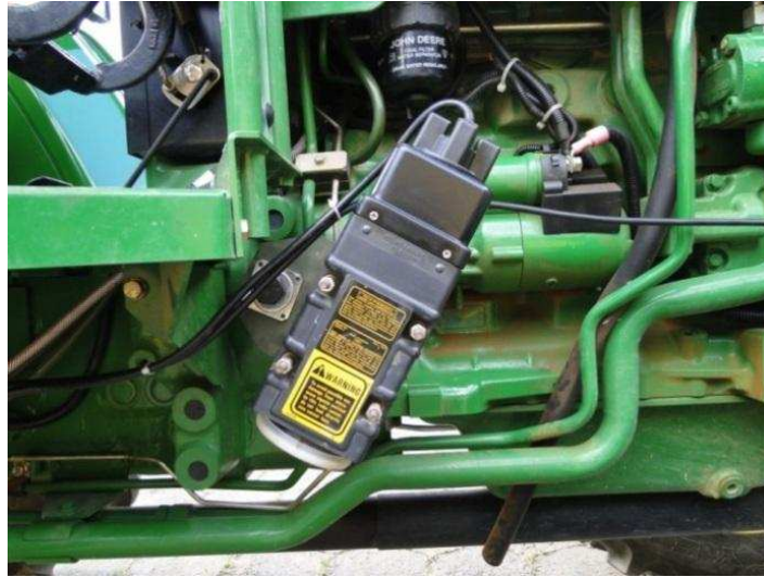
Figura 5. Radar utilizado para mensurar a velocidade.
