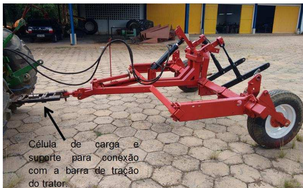
Figura 18. Versão final do protótipo e suporte para conexão com a barra de tração.
