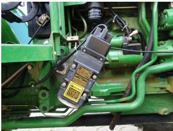
Figura 4. Radar utilizado para medição da velocidade.
