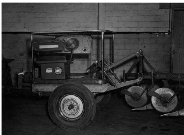
Figura 2. Vista lateral do sistema para determinação da força de tração de implementos montados proposto por Hunt (1954).
