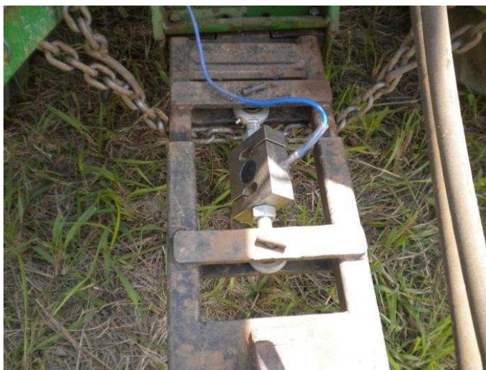
Figura 7. Célula de carga e suporte para instalação no trator.
