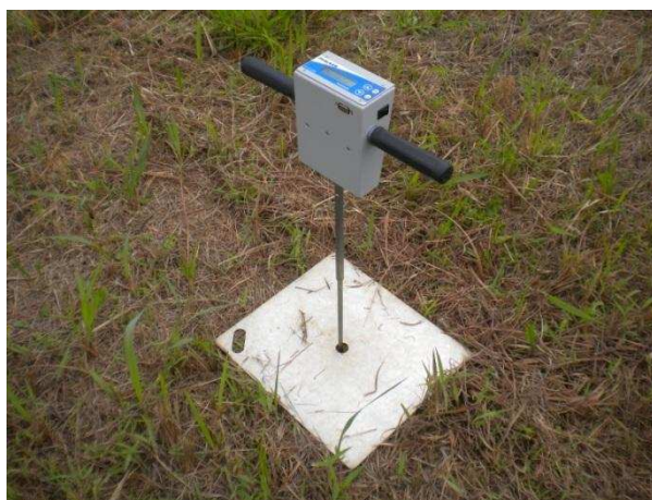
Figura 2. Penetrômetro utilizado na coleta de dados.
