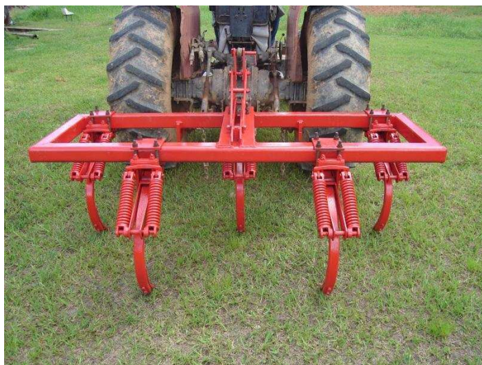
Figura 2. Escarificador utilizado no experimento.
