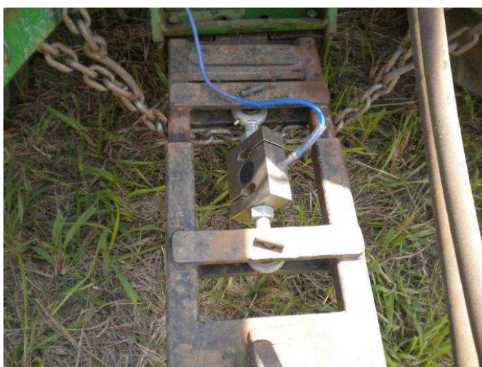
Figura 5. Célula de carga e suporte para instalação no trator.
