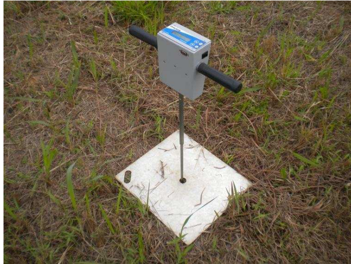
Figura 4. Penetrômetro utilizado na coleta de dados.
