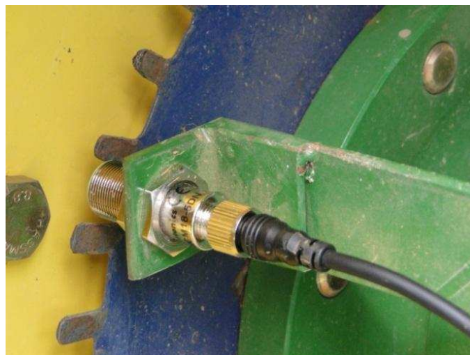
Figura 6. Sensor indutivo utilizado para a determinação da velocidade angular dos rodados.
