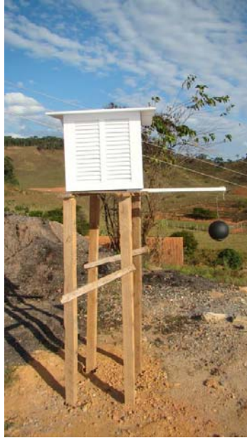
Figura 10 - Abrigo meteorológico instalado entre os dois galpões.
