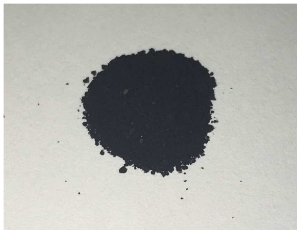
Figura 2.1: Imagem das nanopartículas bimetálicas sintetizadas a partir de baterias íon-Li.
